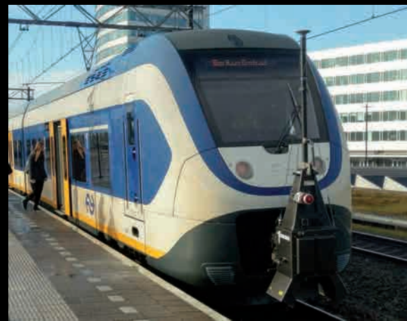
Le système d'acquisition greffé à l'arrière d'un train de voyageurs
