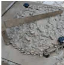
Slump béton contenant des granulats recyclés avec synergie MPolyheed 787 + SBS 3890
