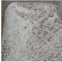
Béton contenant des granulats recyclés avec synergie MPolyheed 787 + SBS 3890
