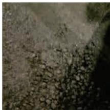
Béton contenant des granulats recyclés adjuvant classique
