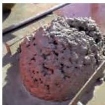
Slump béton contenant des granulats recyclés adjuvant classique)
