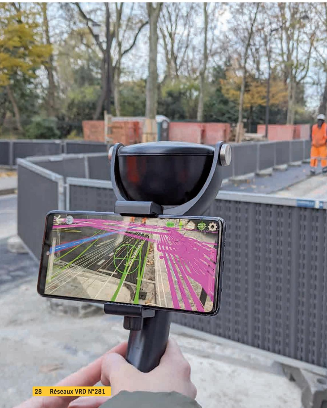
**A**près avoir mené des tests sur un précédent chantier, la SPAC a décidé d'utiliser un récepteur GNSS proposé par la jeune start-up Syslor. But de l'opération : réaliser des plans de recollement précis tout en gagnant du temps. Effectués dans le 19<sup>e</sup> arrondissement de Paris, les travaux concernent une liaison de 125 000 V d'une
