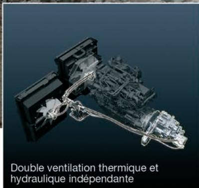
Double ventilation thermique et hydraulique indépendante
